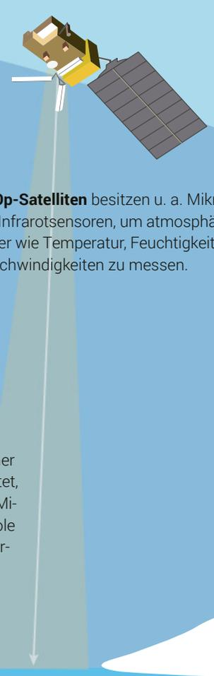
Die **MetOp-Satelliten** besitzen u. a. Mikrowellen- und Infrarotsensoren, um atmosphärische Parameter wie Temperatur, Feuchtigkeit und Windgeschwindigkeiten zu messen.
