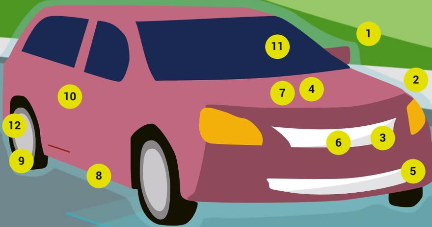
**1 GNSS (GPS):** Ermöglicht Navigation und Standortverfolgung.
