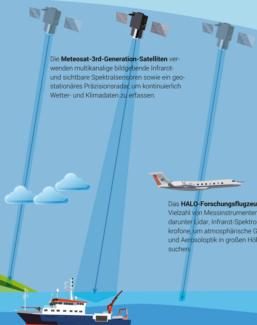
Die **Meteosat-3rd-Generation-Satelliten** verwenden multikanalige bildgebende Infrarot- und sichtbare Spektralsensoren sowie ein geostationäres Präzisionsradar, um kontinuierlich Wetter- und Klimadaten zu erfassen.
