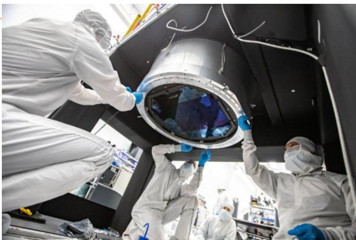
*Die Kamera des Vera-Rubin-Observatoriums besitzt über 3,2 Milliarden Pixel verteilt auf 189 CCD Chips. Man würde 378 4K-Bildschirme benötigen, um ein damit gewonnenes Bild vollständig Pixel für Pixel darzustellen.*
