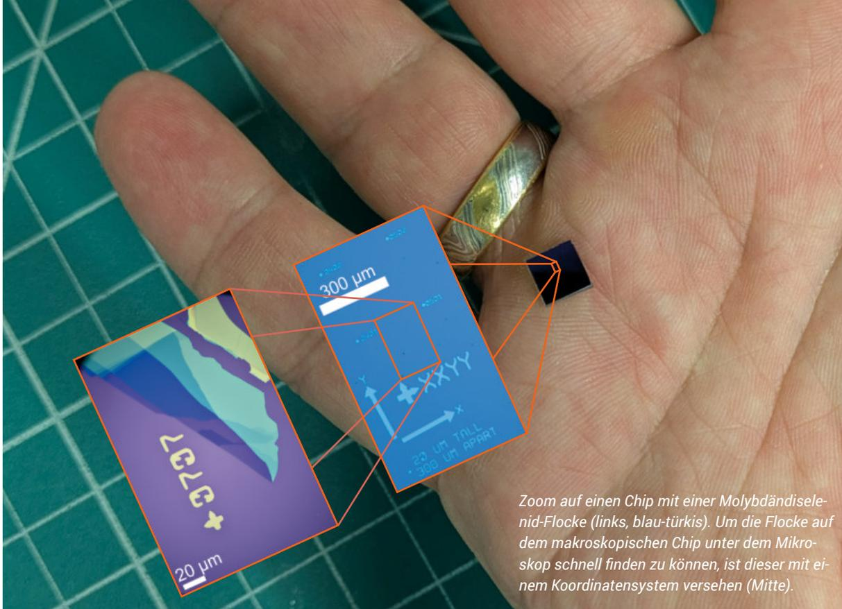
Zoom auf einen Chip mit einer Molybdändiselenid-Flocke (links, blau-türkis). Um die Flocke auf dem makroskopischen Chip unter dem Mikroskop schnell finden zu können, ist dieser mit einem Koordinatensystem versehen (Mitte).
