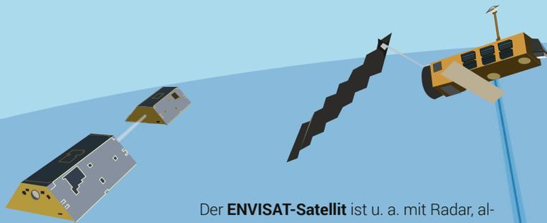
Der **ENVISAT-Satellit** ist u. a. mit Radar, altimetrischen Systemen und Multispektralsensoren zur Messung von Ozeanoberflächentemperaturen, Landbedeckung, Eisveränderungen und atmosphärischen Gasen ausgestattet.
